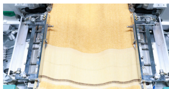
卷边机构 Hemming Mechanism
